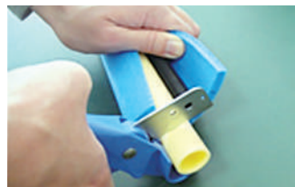
パイプのカット
