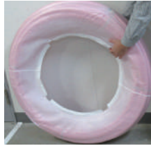
切欠きから手を差し込み、 内周融着部のフィルムを 開いていきます。
