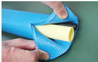
保温材の引裂き
