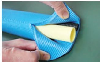
保温材の引裂き
