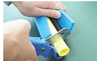
パイプのカット
