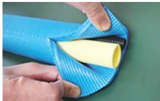
保温材の引裂き
